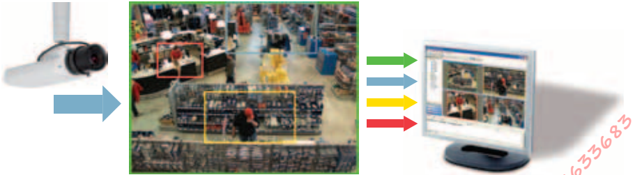
Afbeelding 2.4e Een multi-megapixelcamera. Selectie van bijgesneden weergavegebieden in de volledige weergave. Meerdere virtuele cameraweergaven (maximaal acht weergaven mogelijk).
