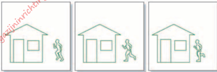
Afbeelding 7.1a Met de JPEG-indeling worden de drie beelden in de bovenstaande reeks gecodeerd en als afzonderlijke unieke beelden (I-frames) verzonden, zonder enige afhankelijkheid van elkaar.
