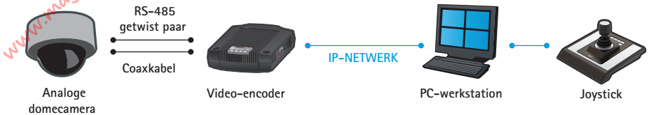
Afbeelding 4.4a Een analoge PTZ-domecamera kan worden aangestuurd via de seriële poort van de video-encoder (bijv. RS-485), zodat de camera extern kan worden aangestuurd via een IP-netwerk.
