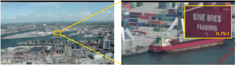
Afbeelding 2.4i Links een totaaloverzicht en rechts een 20x ingezoomd beeld met een HDTV 1080p PTZ-dome-camera waarmee de teksten op het vrachtschip op 1,6 km (1 mijl) afstand kunnen worden gelezen.
