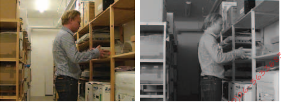
Afbeelding 2.2a Links: een opname in de dagmodus. Rechts: een opname in de nachtmodus.
