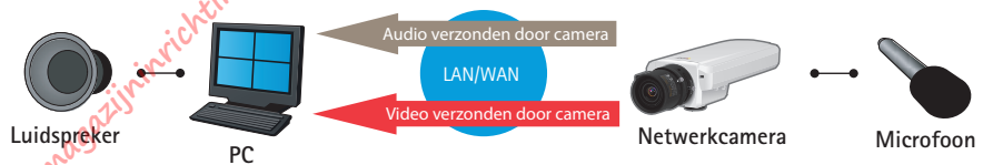
Afbeelding 8.3a In de simplexmodus wordt het audiosignaal in slechts één richting gestuurd. In dit geval wordt de audio door de camera naar de operator verzonden. Toepassingen zijn onder andere externe bewaking en video-surveillance..
