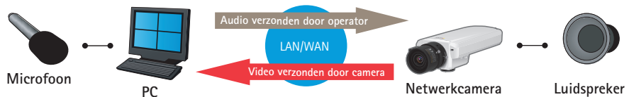
Afbeelding 8.3b In dit voorbeeld van simplexcommunicatie wordt het audiosignaal door de operator naar de camera gestuurd. Dit kan bijvoorbeeld worden gebruikt om een persoon die op de camera zichtbaar is gesproken instructies te geven, of om een potentiële autodief van een parkeerterrein te verjagen.
