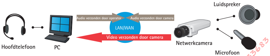
Afbeelding 8.3c In half-duplexmodus kan het audiosignaal in beide richtingen worden verzonden, maar niet tegelijkertijd. Dit lijkt op de werking van een portofoon.
