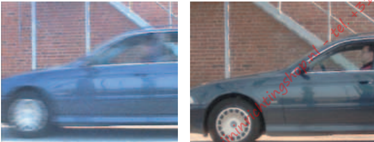
Afbeelding 3.5b Links: een JPEG-beeld (704x576 pixels) van een analoge camera die gebruik maakt van geïnterlineerd scannen. Rechts: een JPEG-beeld (640x480 pixels) van een Axis-netwerkkamera die gebruik maakt van progressieve scantechnologie. In beide camera's is hetzelfde lenstype gebruikt en de snelheid van de auto was in beide gevallen 20 km/u. De achtergrond is op beide afbeeldingen duidelijk te zien. De bestuurder is echter alleen duidelijk zichtbaar in het beeld dat de progressieve scantechnologie gebruikt.
