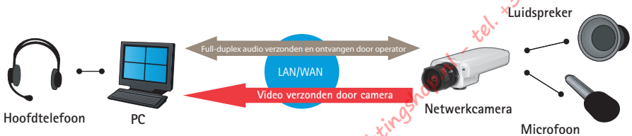
Afbeelding 8.3d In full-duplexmodus wordt audio tegelijkertijd van en naar de operator verzonden. Deze communicatiemodus lijkt op een telefoongesprek. Full-duplex vereist dat de client-pc over een geluidskaart beschikt die full-duplex audio ondersteunt.
