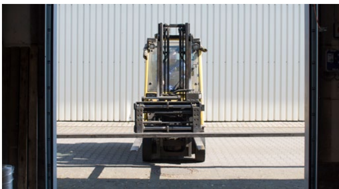
Transport van langgoedmateriaal door poorten is zonder LSL niet mogelijk
