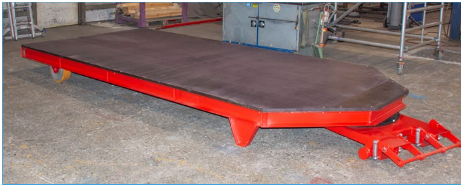
STS met anti-slip betonplexplaten
