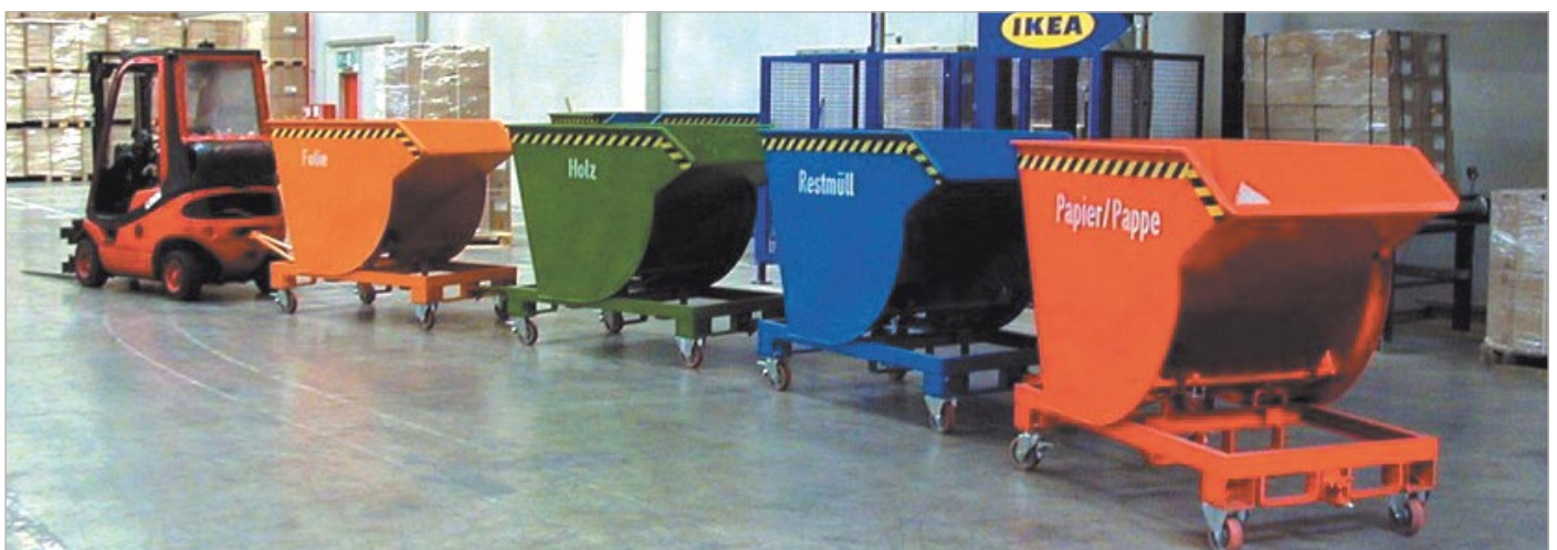
BKM met wielen en aanhangerinrichting met dissel
